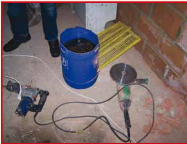
Figuur 22: Een rondslingerend snoer in het atelier vormt een risico op brand (links) terwijl het uittrekken van een stekker via het snoer kan leiden tot beschadiging (rechts).
