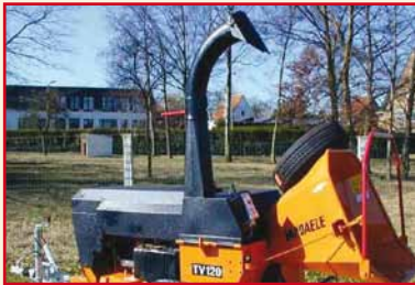
Figuur 42: Een beveiliging tegen overbelasting op een hakselaar (links) kan voorkomen dat een machine gaat branden en volledig uitbrandt (rechts)
