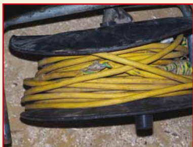
Figuur 23: Bij gebruik van een verlengsnoer mag men het snoer nooit met tape herstellen (links) en moet men het snoer steeds ontkrollen (rechts)
