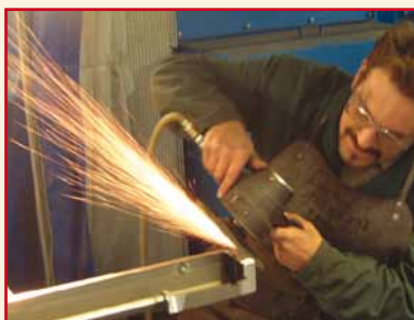
Figuur 35: Een slijpschijf die schuurt over een metalen oppervlak produceert gensters (links) Lasdoeken ophangen in een werkplaats zorgt voor afscherming (rechts)
